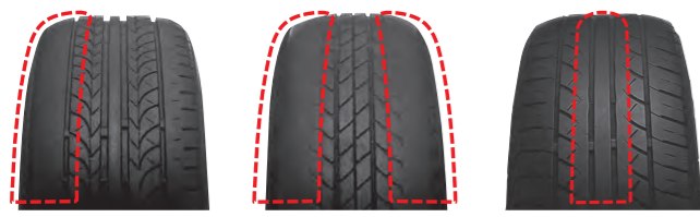
片側摩耗 両肩摩耗 センター摩耗
