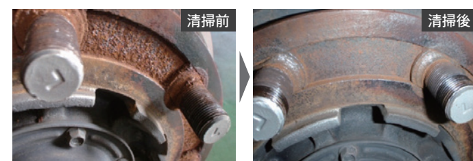
清掃前 ハブやボルトに錆や汚れが付着し 確実な車輪取り付けができない状態
